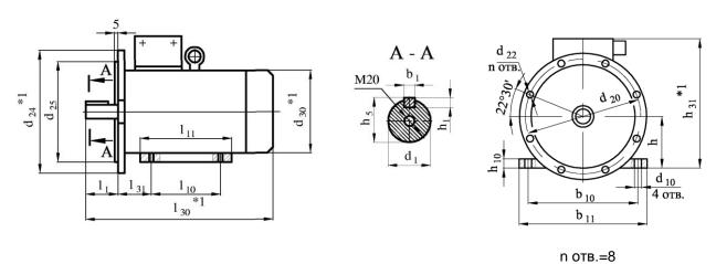
\* 1 Габаритные размеры даны для справок. Предельные отклонения на установочные и присоединительные размеры по ГОСТ 8592.
